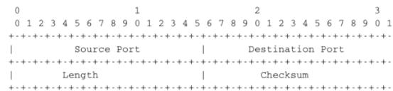
Fig. 3.19: UDP Header Format
